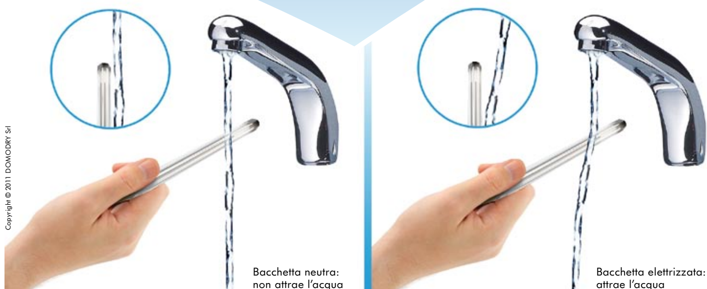
Fig.1 – Deviazione di un flusso d'acqua per attrazione elettrostatica
